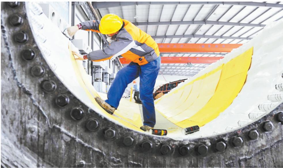
12月27日,南通东泰新能源设备有限公司车间,工人在检验风机叶片芯材,为下一步真空灌注和导入树脂做准备。东泰公司是专业从事兆瓦级风力发电机叶片、整机研发和生产的江苏省高新技术企业,是全国第一家采用碳纤维生产风机叶片的厂家。今年以来,东泰公司生产风电叶620支,产值达3.5亿元。
