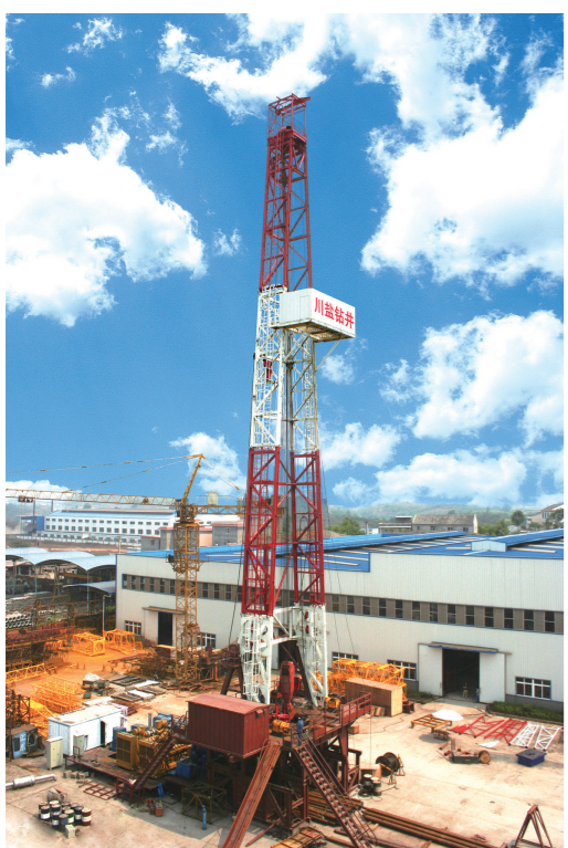
四川盐业地质钻井大队机修车间自主设计制造的井架“起立”成功
