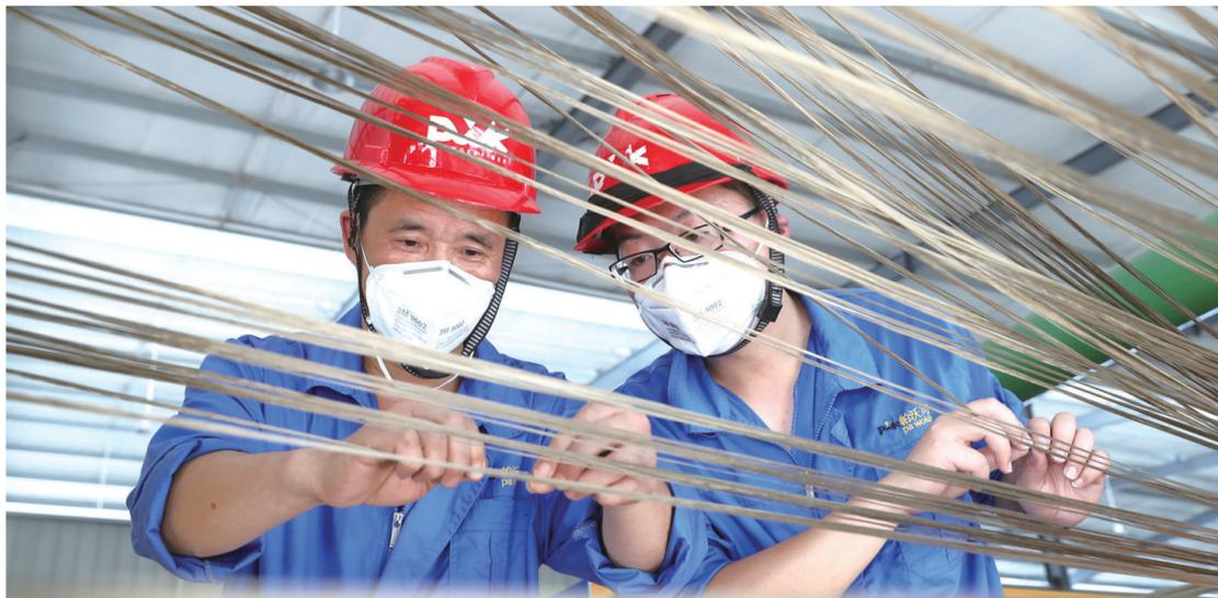
广安市立足资源优势,引进世界先进的矿物纤维生产技术,以华菱帕沃矿物纤维制品有限公司为龙头,对华菱境内丰富的玄武岩、白云石等石资源实施生态保护性综合利用,变废为宝,点石成金,制作成新型节能环保建筑保温隔热、吸音降噪、阻燃的矿物纤维产品。这些产品不仅具有节能环保、绿色环保、防火防水等特点,还能广泛应用于建筑、军事、航天等领域。图为6月21日,员工检测利用玄武岩生产的连续纤维。(邱海鹰 摄影报道)
