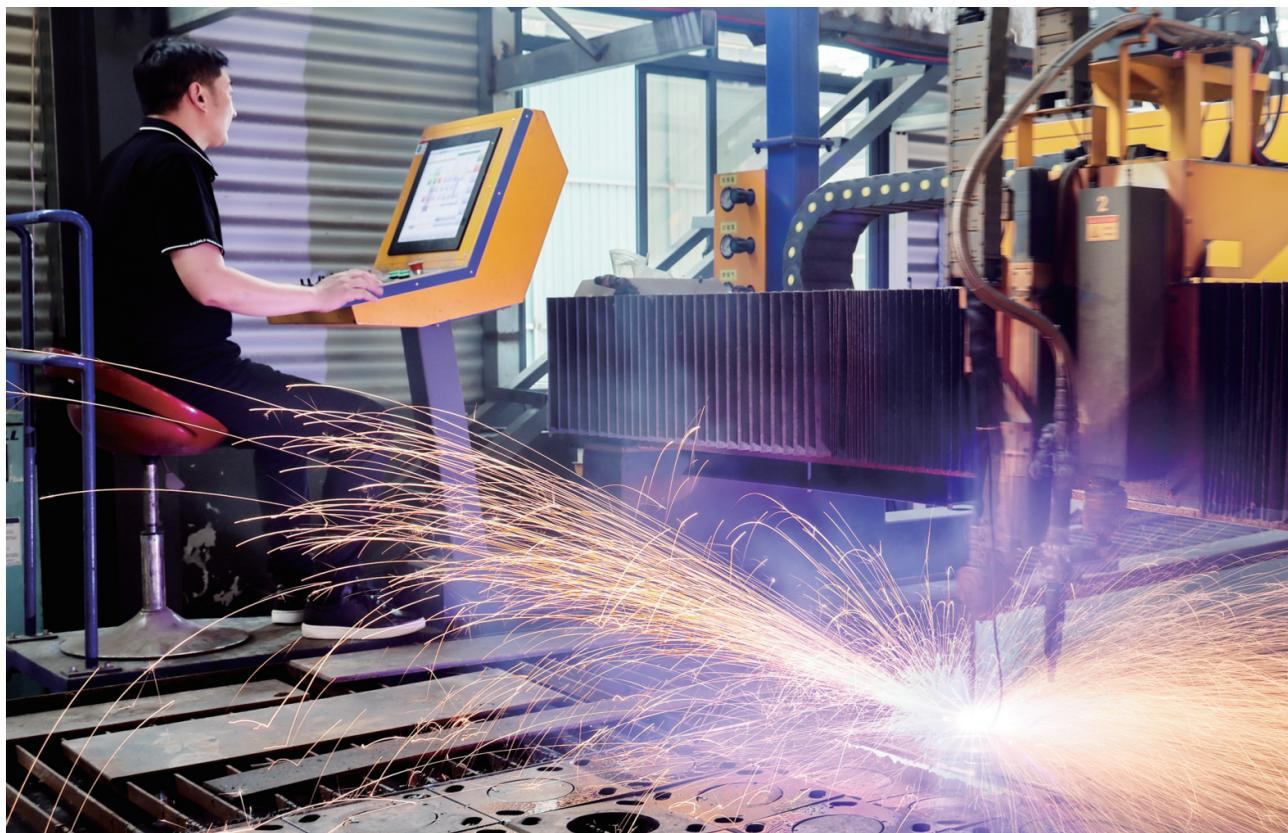
近日,位于沭阳经开区的江苏司记照明有限公司车间内,等离子切割机正在切割路灯用的钢板和装饰配件,工人们则忙着焊接路灯法兰、装配电路板、喷涂路灯杆,呈现一派忙碌的生产景象。
