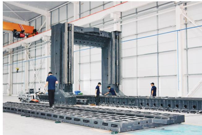
9月17日,在宿城经济开发区的乔那科数控装备(江苏)有限公司生产车间内,工人正在组装大型数控龙门加工中心。
