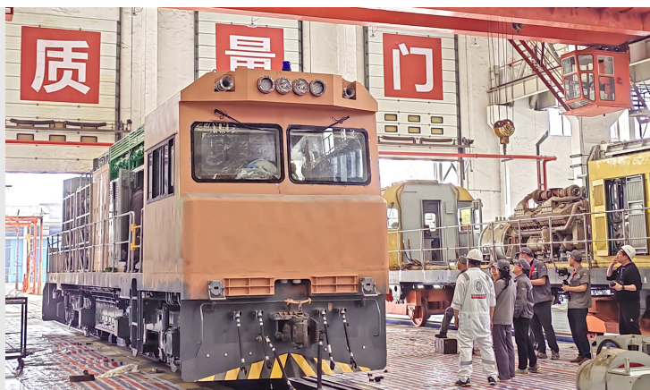
4月16日，中车戚墅堰机车有限公司首台出口智利的氢能机车顺利落车，预计6月实现厂内交付并发运。该机车采用400kW氢燃料电池、600kW大容量蓄电池，以及35MPa高压车载大容量储氢系统，将用于铁路货物运输。 袁彩霞 李佳蔚 戴雪燕 摄
