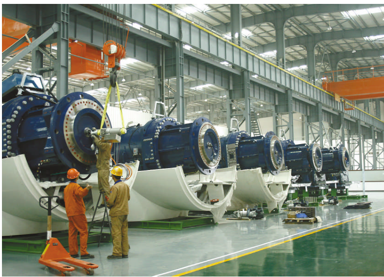
图为华锐风电盐城产业基地 1.5 兆瓦风电机组装配现场。 应伟 摄
