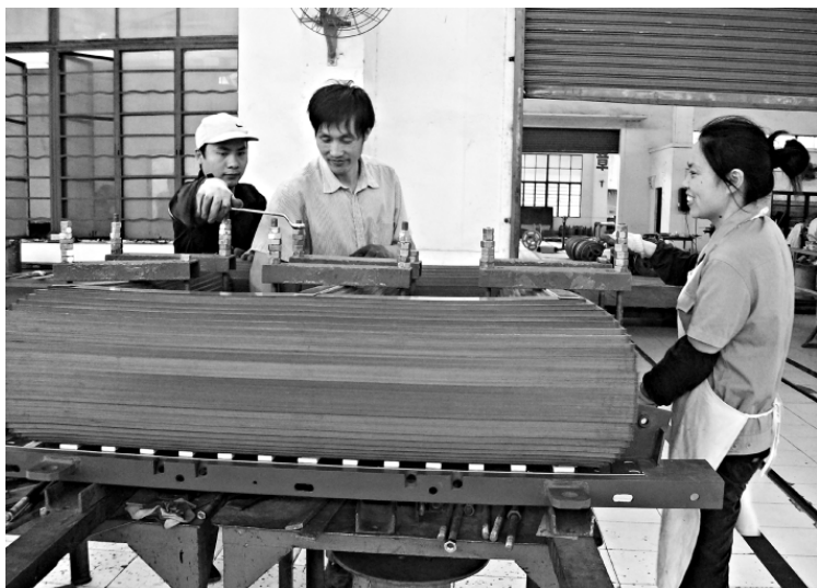
7月份以来,龙冈镇结合“创先争优”活动,一着不让迅速掀起“决战三季度,奋力夺全年”活动热潮,努力夺取经济工作全胜。图为7月26日,华星变压器有限公司员工在组装大容量变压器。 顾仁洋 摄
