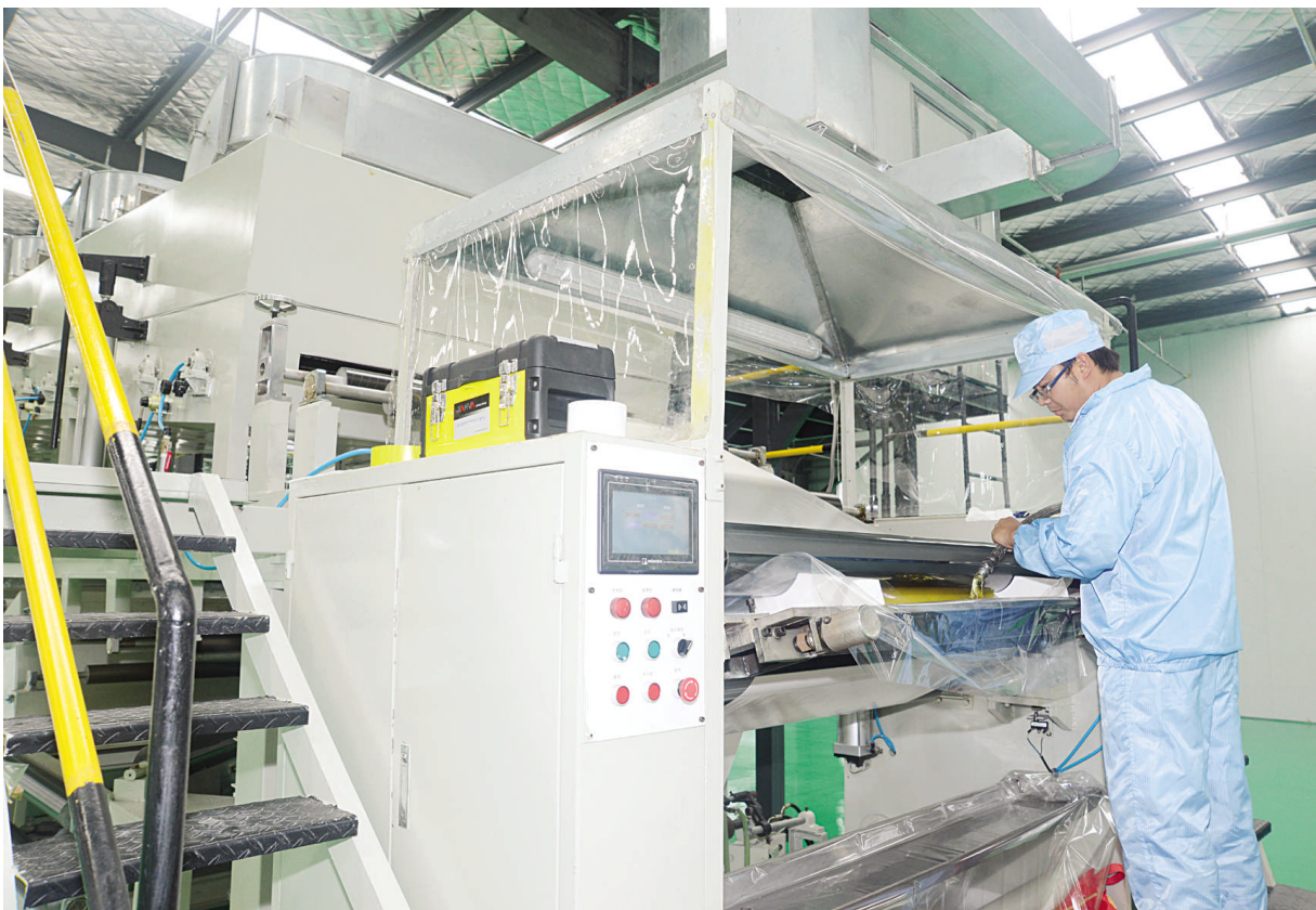
楼王镇引进的斯瑞达高分子材料项目,计划总投资 2200 万美元,新征土地 36 亩,建筑面积 1.92 万平方米。项目竣工投产后,可实现年销售 1.2 亿元、利税超 1000 万元。图为该公司投资 800 多万元新上的 1 套复合涂布设备,主要生产光学薄膜、多功能保护膜、密封胶带等产品,应用于电子、电器、光伏、医疗设备、汽车等行业精密零部件的装配、电磁兼容及绝缘、超导等问题处理,全球只有德、美、日、中 4 个国家具有该生产技术,而该公司又是我国唯一的生产企业。 本报记者 陈雁程 摄
