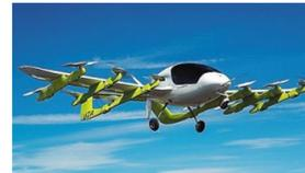
Kitty Hawk公司表示,这种飞行出租车有三个独立的飞行计算机,即使坠毁也能继续导航。每个旋翼都
