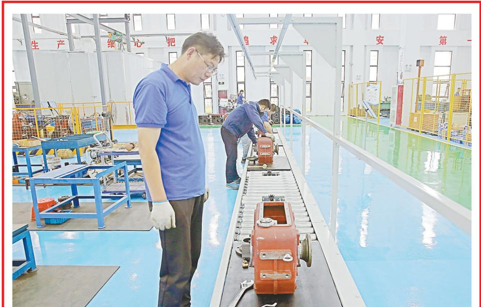
位于张庄街道的普兹智能分动箱项目由普兹传动机械(上海)有限公司投资建设,项目总投资5000万元,其中固定资产投资2000万元、设备投资3000万元,购置数控成型磨齿机、数控控铣床、CNC等设备,新上智能分动箱生产线,全部投产后可年生产各类分动箱3000台,实现营业收入5500万元,税收200万元。图为该公司员工正在生产车间内作业。
